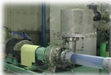
大容量マイクロナノバブル発生装置:大学等と共同研究を行って開発したもので、本装置はポンプ吸込口から入れた気体を特殊ポンプで予備攪拌後、バブル発生器で50 $\mu$ m以下の超微細気泡を生成するもの。微細気泡は、化学薬品を使わずに水中の細かな不純物を取り除く。オゾンによる殺菌、脱色、脱臭にも最高の効果を発揮する。
