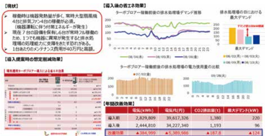
排水処理場の曝気槽用ターボプロアー導入によるエネルギー削減
